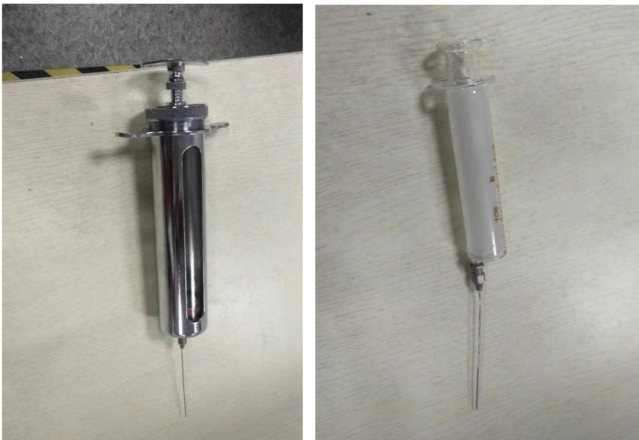
图 4-4 取样针图实
